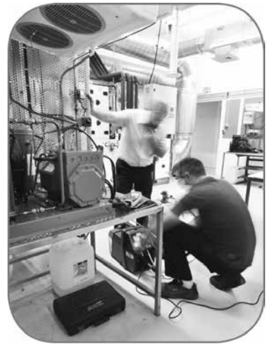
Essais aéronautiques en laboratoire sur une centrale de traitement d'air © CETIAT
